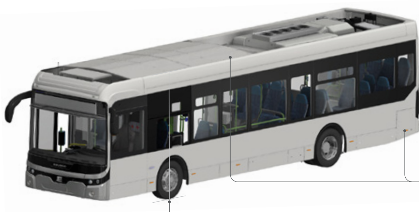
PLAATSING ACCU DAK EN ACHTERIN
