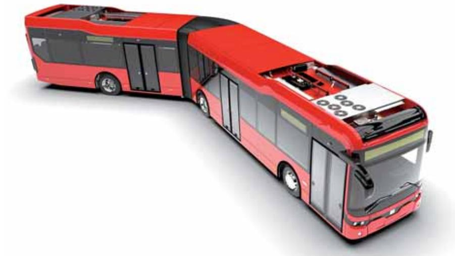
Beim Ebusco 2.2 Gelenk sind sämtliche Akkupacks auf dem Dach untergebracht, sie befinden sich unter den Abdeckungen vor und hinter dem Gelenk. Ganz vorne erkennt man die Klimaanlage für den Vorderwagen, dahinter Ladeschienen. Auf dem Nachläuferdach befinden sich hinter den Batteriepaketen der Ausbläser für die Klimaanlage und anschließend diese selbst.
