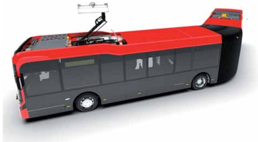
Dieses Bild veranschaulicht die unterschiedlichen Schnellladeoptionen mittels normalem oder invertiertem Pantograph, letzterer dockt an die Ladeschienen an.
