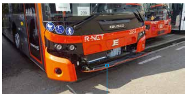
En cas de chocs éléments modulaires permettent de changer seulement la partie endommagée.
